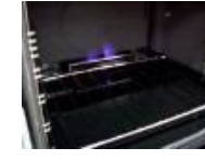
Four gaz à chauffe directe
